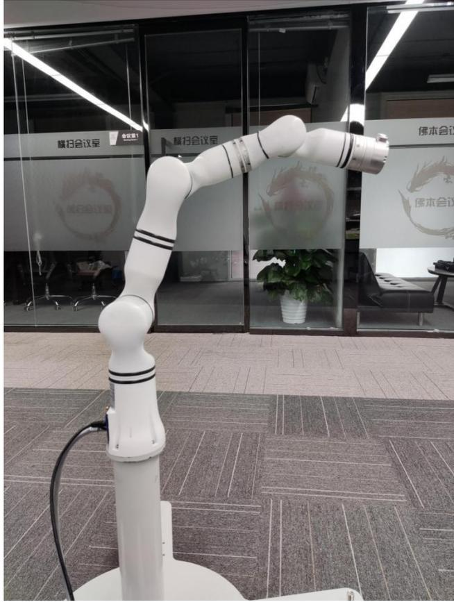
图 7-4 真实机械臂按照 rviz 中 MoveIt!规划的路径运动到相同位置
